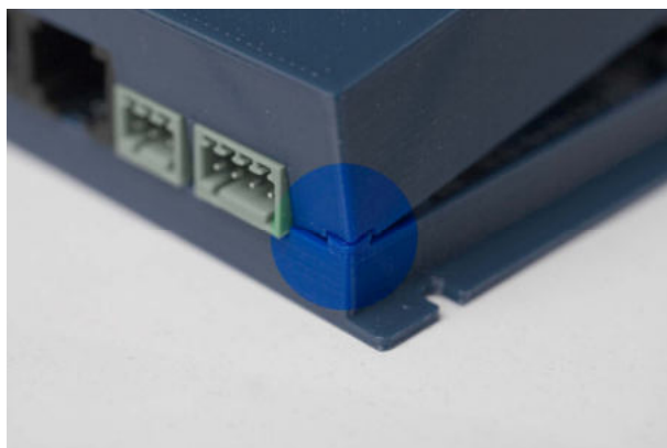
Fig 4: Sluiten van de behuizing
